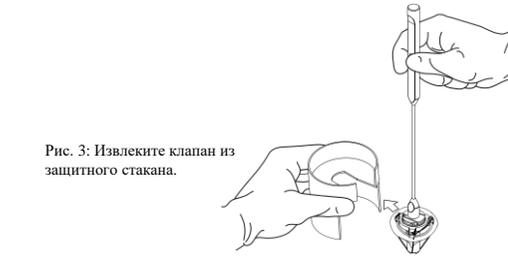
Рис. 3: Извлеките клапан из защитного стакана.
