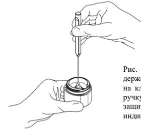
Рис. 2: Прикрутите ручку к держателю, который зафиксирован на клапане, ОСТОРОЖНО вдавите ручку до щелчка, извлеките защитный стакан с клапаном из индивидуального контейнера.
