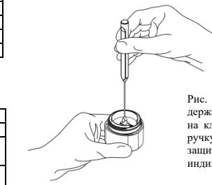
Рис. 2: Прикрутите ручку к держателю, который зафиксирован на клапане, ОСТОРОЖНО вдавите ручку до щелчка, извлеките защитный стакан с клапаном из индивидуального контейнера.
